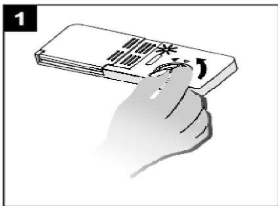
Чтобы открыть резервуар, прокрутите крышку до положения «открыто» (стрелка влево) и снимите крышку.
